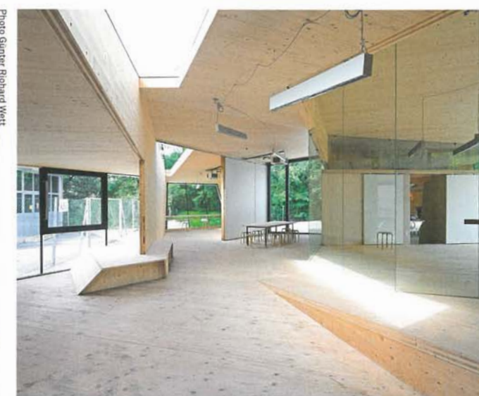
Gebaut aus 1,25 Meter breiten Fichten-Brettsperholzplatten Built of untreated, 1.25 metre-wide cross laminated spruce
